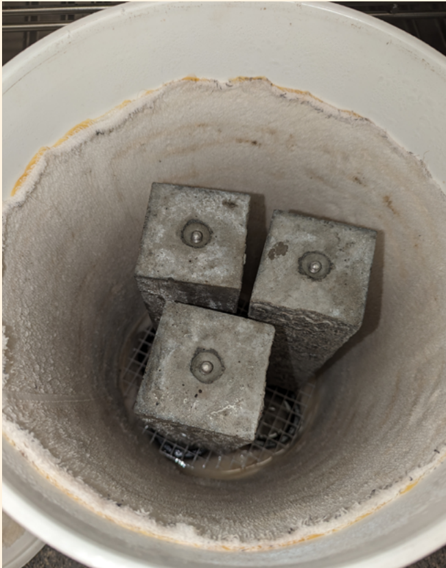
Figure 2a – Essais CSA A23.2-28A : conditionnement des échantillons.
