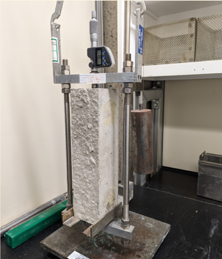
Figure 2b – Essais CSA A23.2-28A : mesure de déformation des échantillons.
