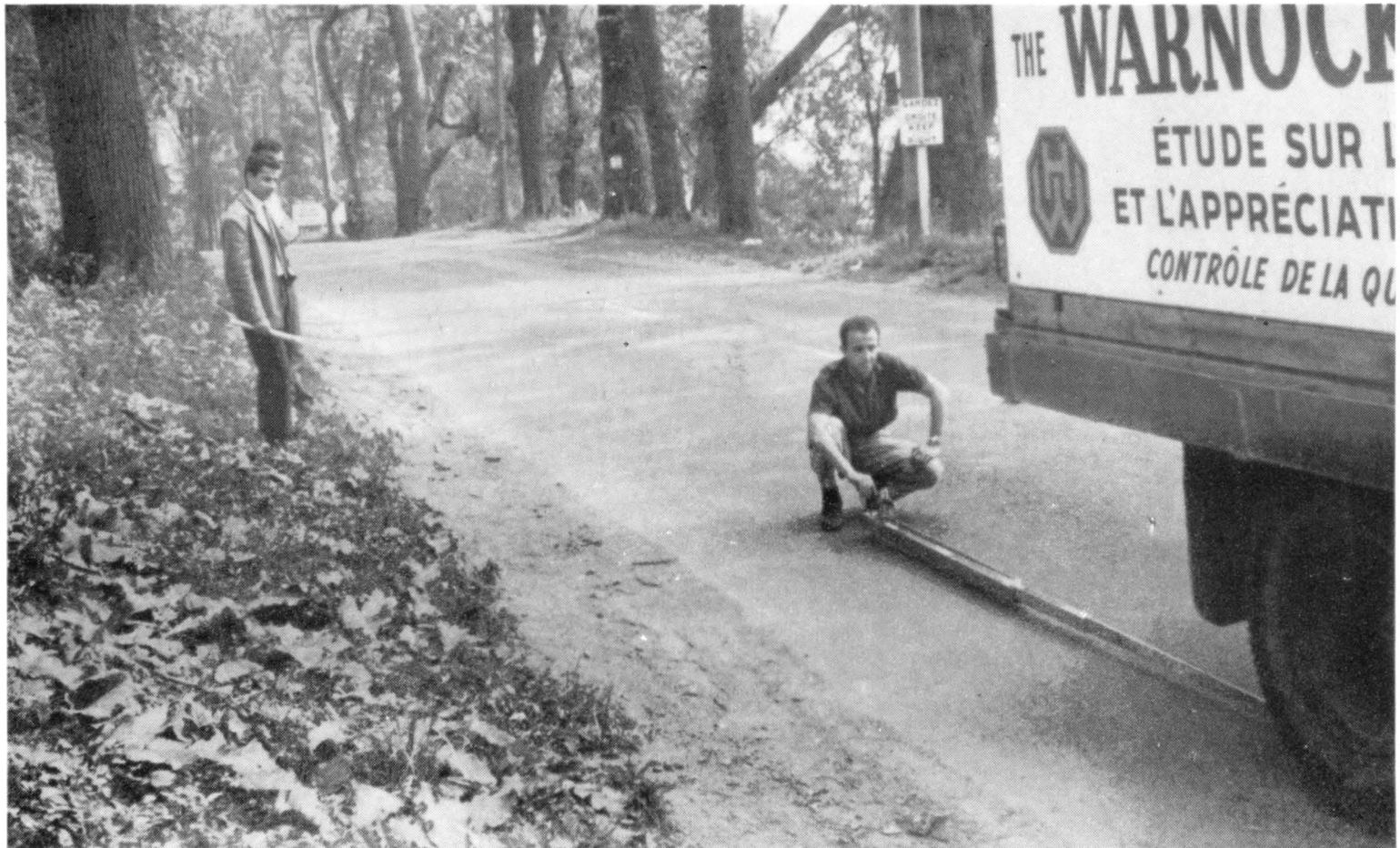
► A l'aide du déflectomètre Benkelman, des spécialistes vérifient la résistance de la chaussée sous le poids de charges répétées. 30,000 essais de ce genre se poursuivent présentement sur les principales routes de la province.
