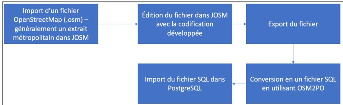
Figure 2-46. Processus de codification d'un réseau piéton intérieur en utilisant des données d'OpenStreetMap
