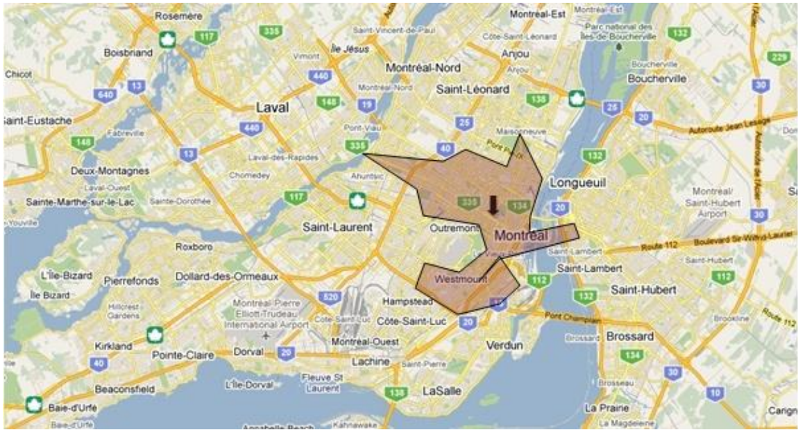
Figure 56. Exemple de polygone avec un temps de parcours de 15 min en transport collectif
