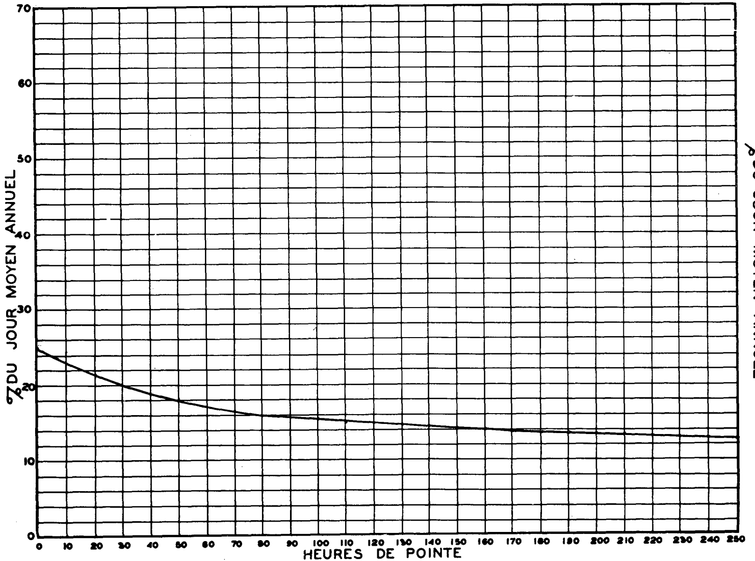
RELATION ENTRE LES HEURES DE POINTE ET LE JOUR MOYEN ANNUEL STATION: MONTMORENCY (PONT ILE D'ORLEANS) ROUTE N° N.N. 31-120
