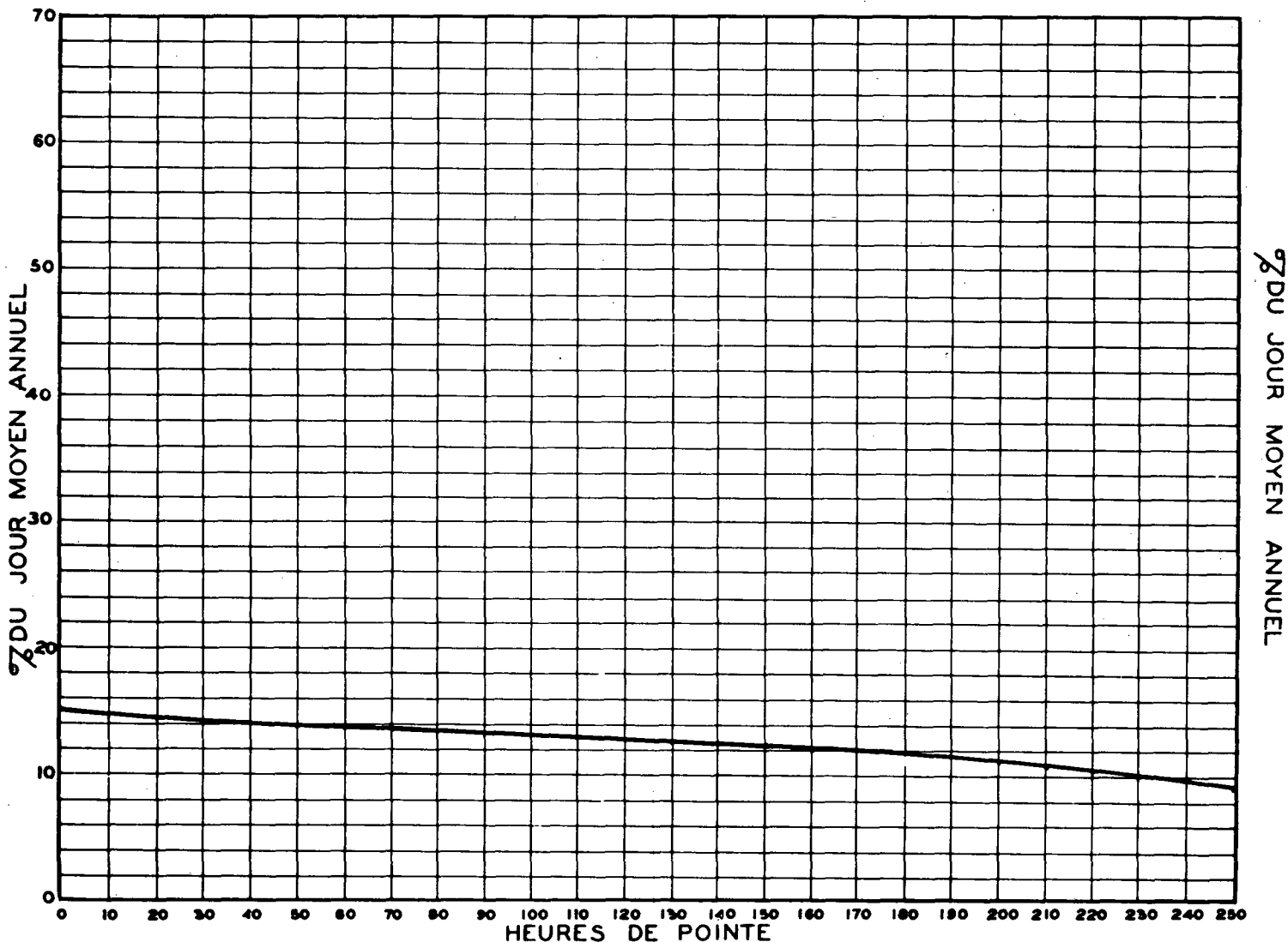
RELATION ENTRE LES HEURES DE POINTE ET LE JOUR MOYEN ANNUEL — STATION: POINTE AUX TREMBLES (PONT LE GARDEUR EST) ROUTE N° 138-63-702
