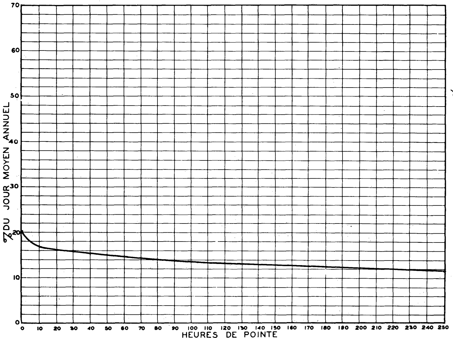
RELATION ENTRE LES HEURES DE POINTE ET LE JOUR MOYEN ANNUEL — STATION: BETSIAMITES ——— ROUTE N° 138-31-175 —
