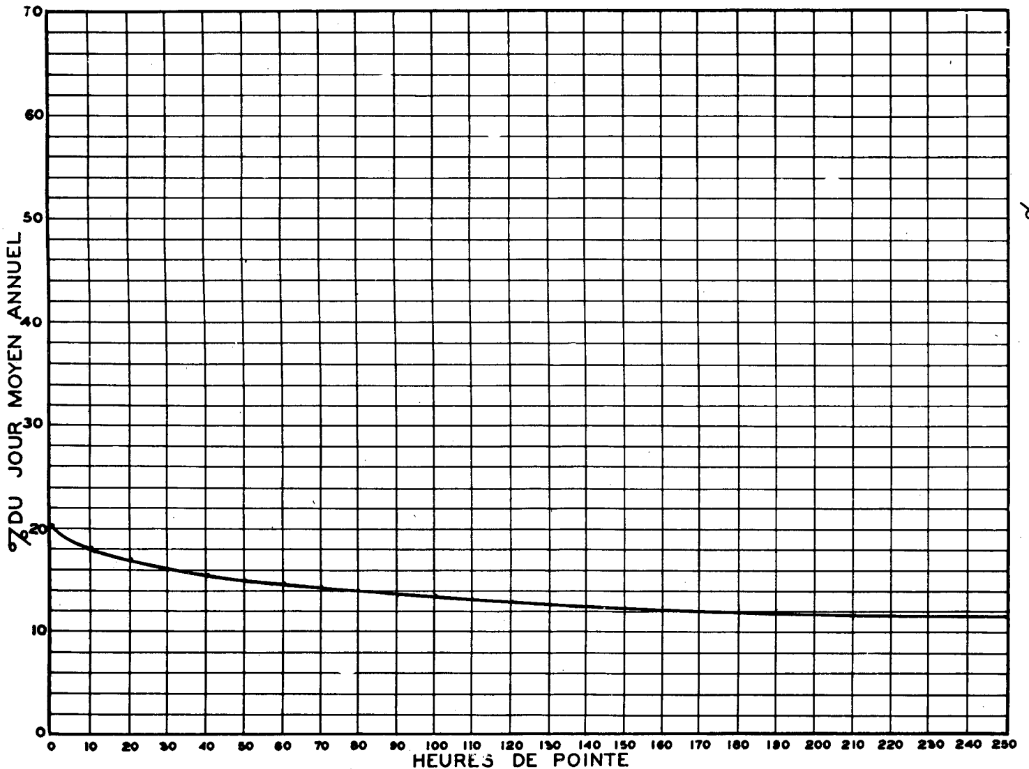
RELATION ENTRE LES HEURES DE POINTE ET LE JOUR MOYEN ANNUEL — STATION: ST-ETIENNE ROUTE N°5-32-7
