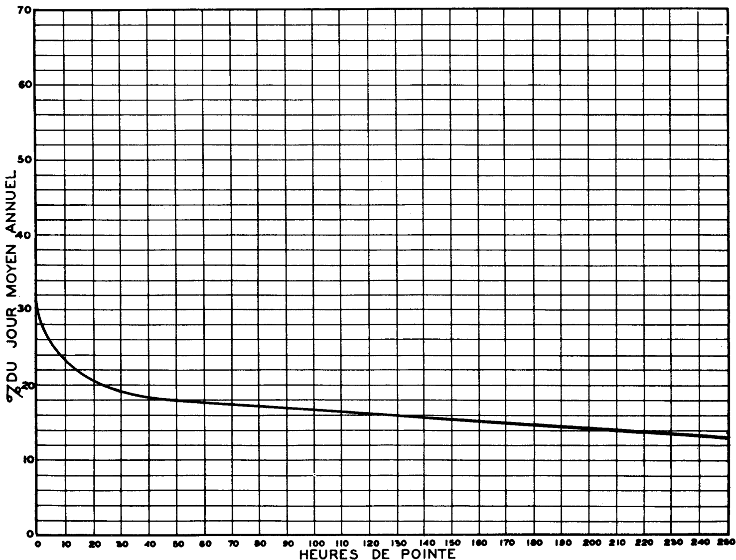
RELATION ENTRE LES HEURES DE POINTE ET LE JOUR MOYEN ANNUEL — STATION: ST-PIERRE-D'ESCOURT ROUTE N° 51-2-2
