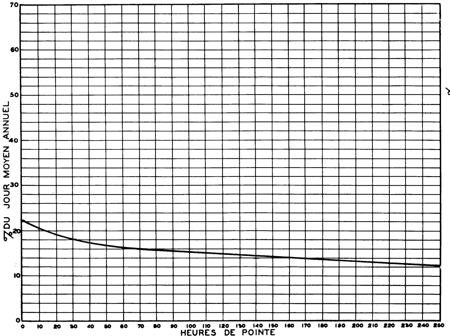
RELATION ENTRE LES HEURES DE POINTE ET LE JOUR MOYEN ANNUEL — STATION: ST-FIDELE ROUTE N° 15-7-6
