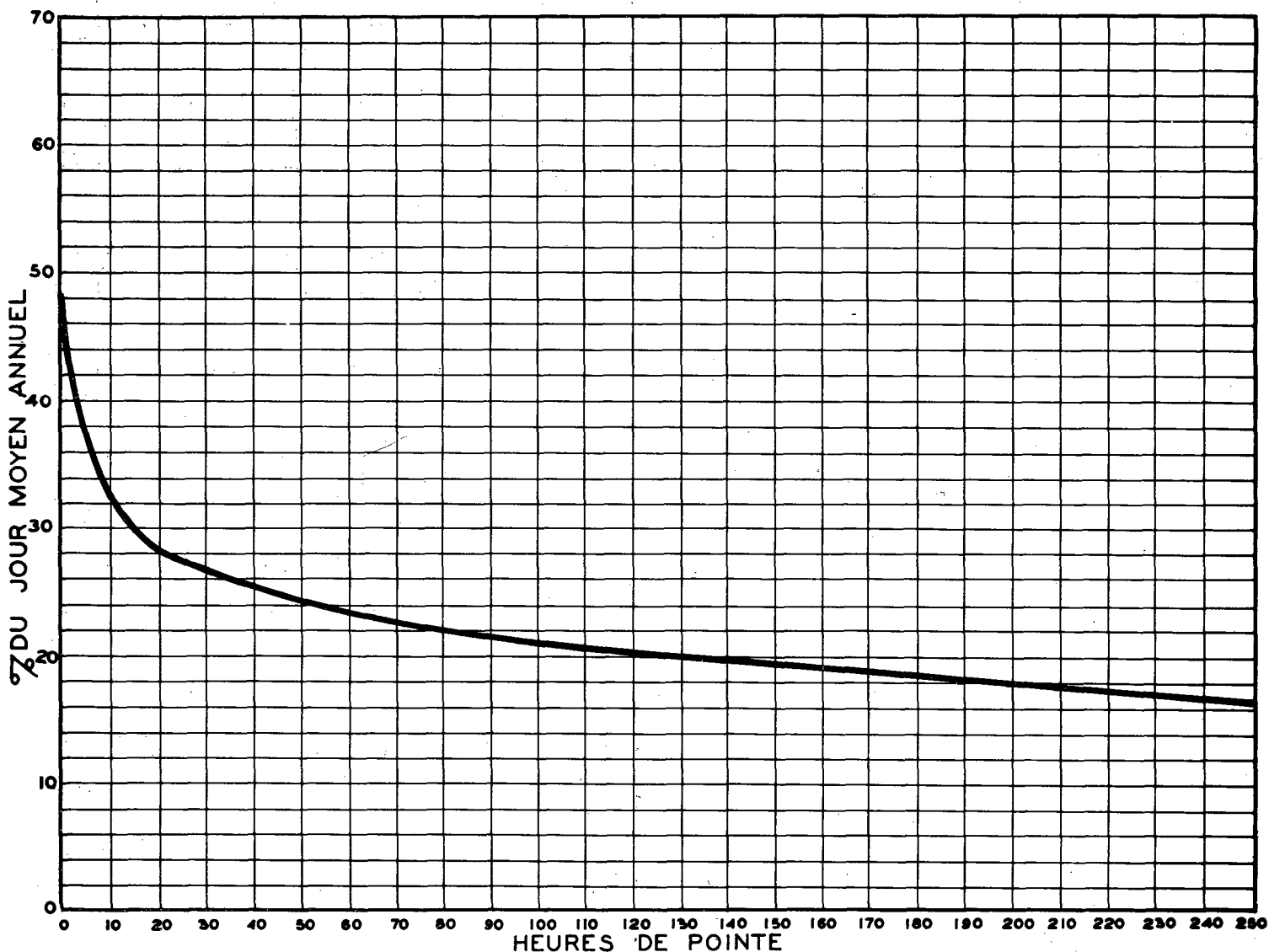
RELATION ENTRE LES HEURES DE POINTE ET LE JOUR MOYEN ANNUEL STATION: RIVIERE BEAUDETTE ROUTE N° 2-4-55
