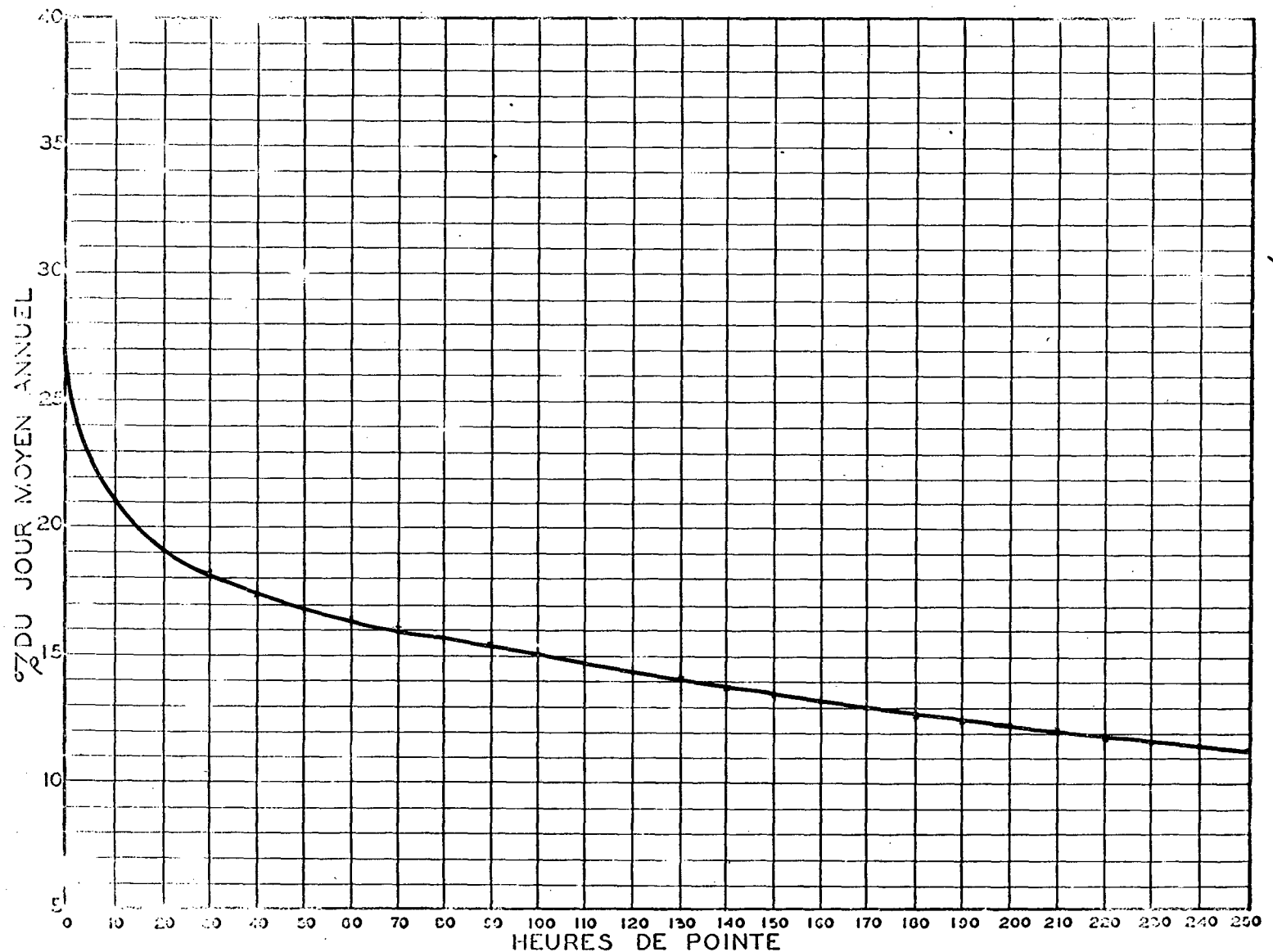
RELATION ENTRE LES HEURES DE POINTE ET LE JOUR MOYEN ANNUEL STATION: STORNGWAY ROUTE N° 34
