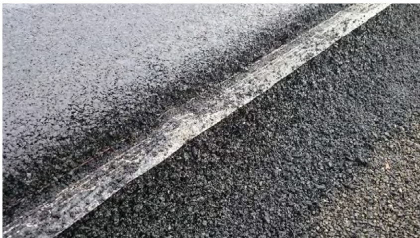
Exemple de structure bitumineuse renforcée par grilles de verre test du projet ANR SolDuGri
