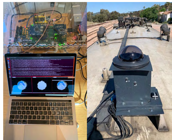
Équipement (PREDISSAT) développé et installé sur un train pour une campagne de détection des signaux GNSS indirects reçus © Juliette Marais
