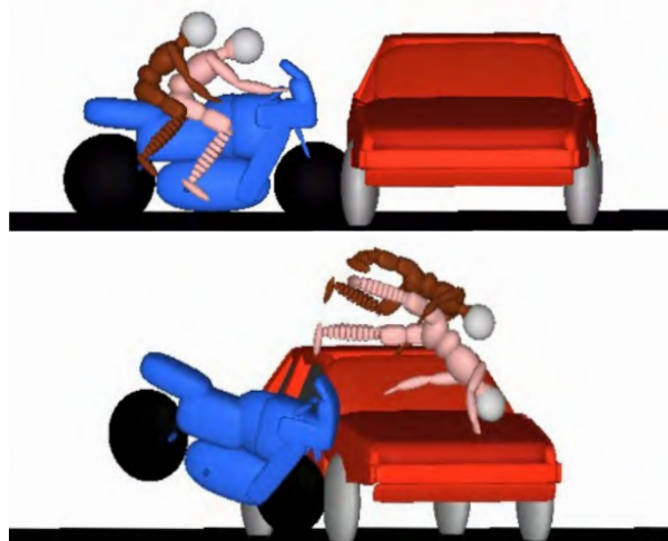
Cinématique de deux occupants d'un deux-roues motorisé en choc frontal © Catherine Masson
