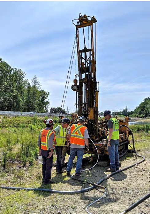
Essais du Permeafor développé par l'Université du New Hampshire (UNH) avec la future Université Gustave Eiffel pour le compte du Département des Transports de l'État du New Hampshire (NHDOT). Permeafor / essais de diagraphe de perméabilité en forage développé par Ursat dans le cadre du RST.
