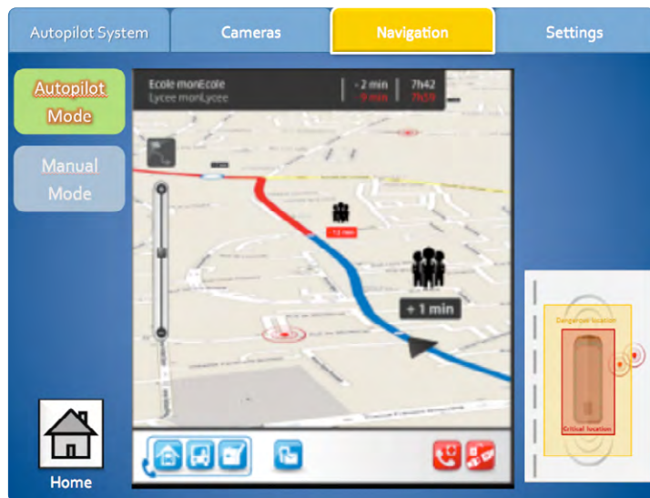
Proposition d'une interface homme-machine (IHM) pour un bus ayant un accostage automatisé
