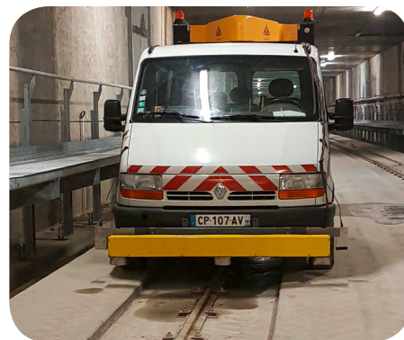
NEOVAL : véhicule instrumenté sur planche de roulement
