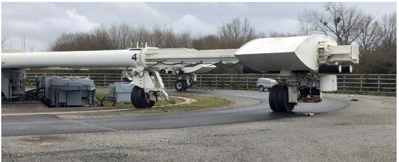
Test comparatif sur le manège de fatigue de chaussées constituées de EME2 et de 3 solutions innovantes à base de matériaux biosourcés et d'enrobés recyclés.
