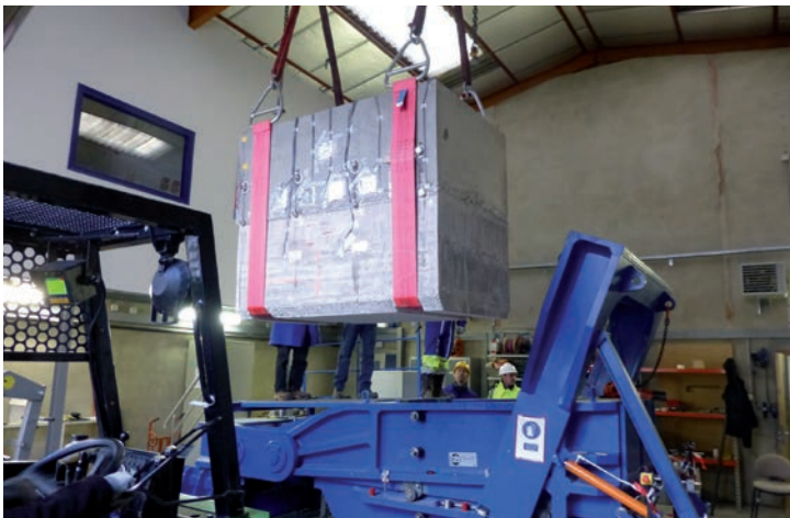
Mise en place d'une éprouvette métrique dans la grande boîte de cisaillement direct du Cerema
