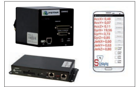
Boîtiers Emma (Enregistreur embarqué des mécanismes d'accidents): version 2, version 3 et version « EmmaPhone »
