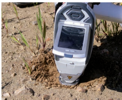
Mesure in situ à l'aide d'un spectromètre de fluorescence X portable
