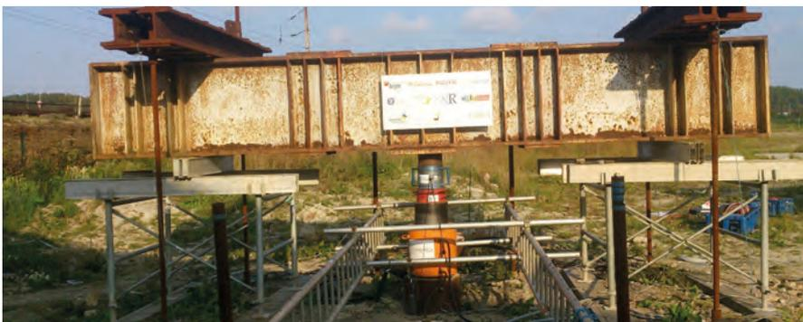
Essai de chargement d'un pieu géothermique
