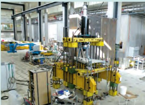
Montage en cadre fermé pour l'essai de flexion des triangles en BFUP
