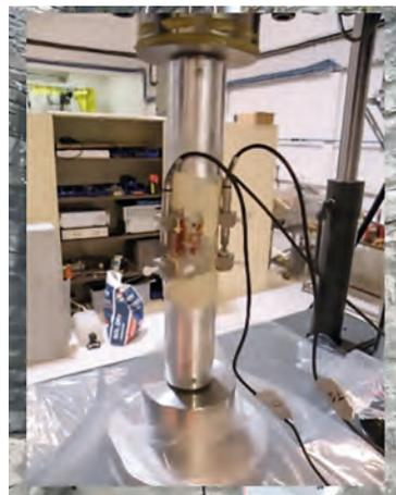
Essai de traction directe sur une éprouvette de mortier de 50 mm de diamètre
