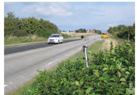
Mesure du bruit de roulement au passage (méthode ISO 11819-1) sur la planche d'essais poro-élastique de Kalvehave au Danemark
