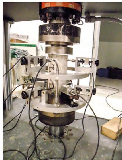
Caractérisation du module de Young d'une carotte de béton prélevé sur une culée du CNIT (Ifsttar/MAST/EMMS)
