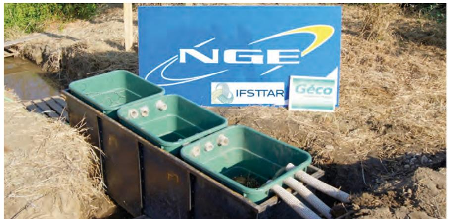
Dispositif de filtration gravitaire des eaux de ruissellement
