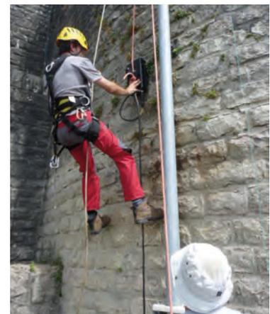
Mesures radar sur la tour de prise d'eau du barrage de Chazilly avec des cordistes
