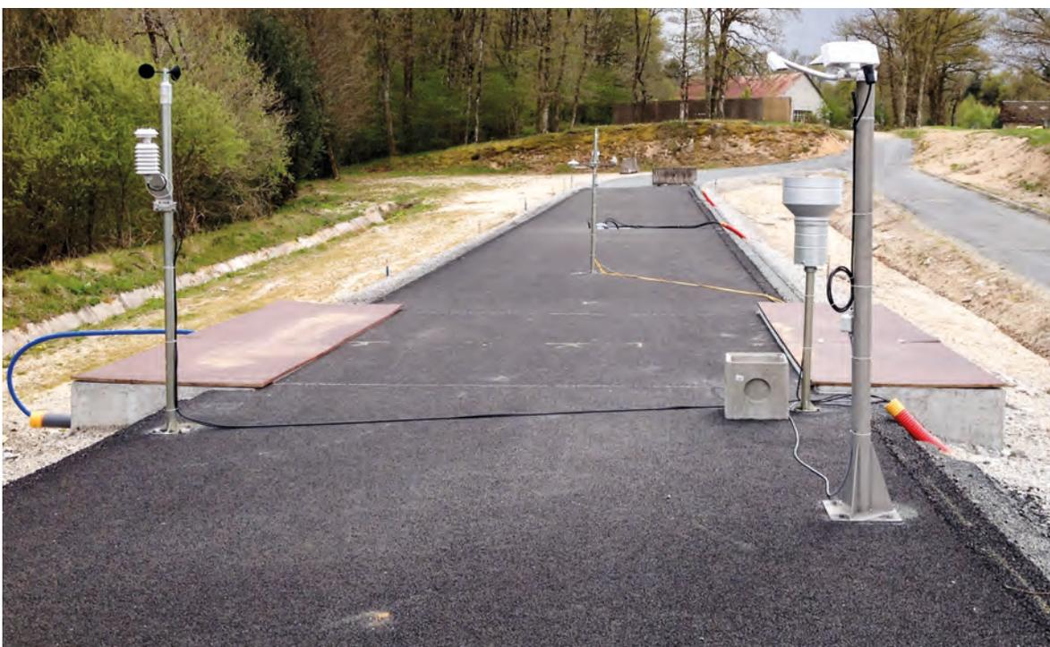
Démonstrateur de chaussée chauffante thermodynamique à Égletons
