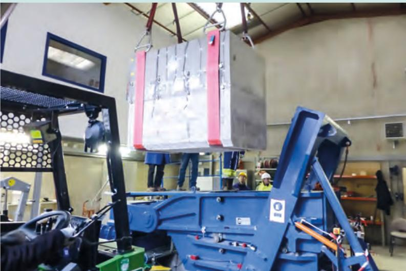
Mise en place d'une « éprouvette » granite-béton de cinq tonnes dans la grande boîte de cisaillement du centre Cerema de Bron avant les essais
