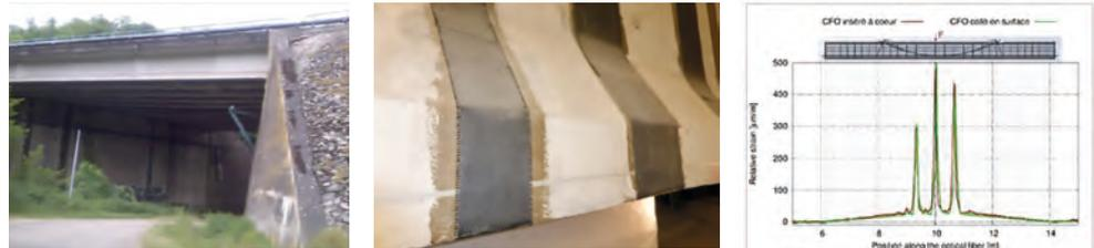
De gauche à droite, pont de la Varèze, fibres collées, amplitudes des déformations mesurées le long de la fibre et indiquant l'emplacement des fissures
