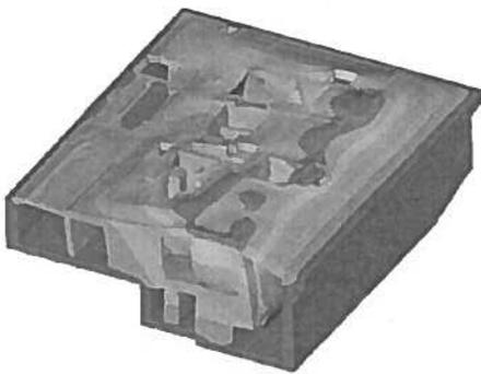
Le bloc représenté sur cette figure constitue 1/4 de la centrale (trois autres blocs sont situés les uns à la suite des autres). Ses dimensions sont approximativement 40 m de long, 30 m de large et 10 m de haut. Les déplacements maximaux sont de l'ordre de 3 à 5 mm (les déformations ont été amplifiées pour être visibles sur la figure)
