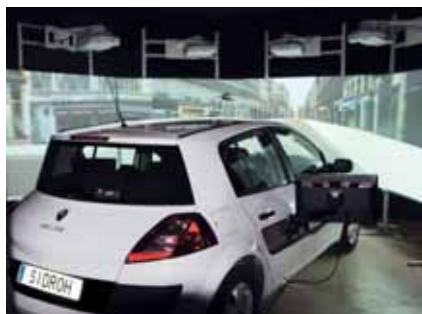
CE NOUVEAU SIMULATEUR DE CONDUITE PERMETTRA, ENTRE AUTRES, D'Étudier LES EFFETS DE L'ALCOOL AUPRÈS DES JEUNES CONDUCTEURS ET DES CONDUCTEURS EXPÉRIMENTÉS
