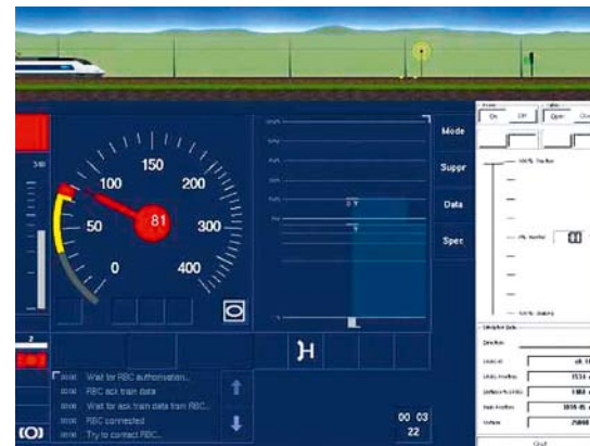
Affichage des vitesses du train sur l'interface ETCS
