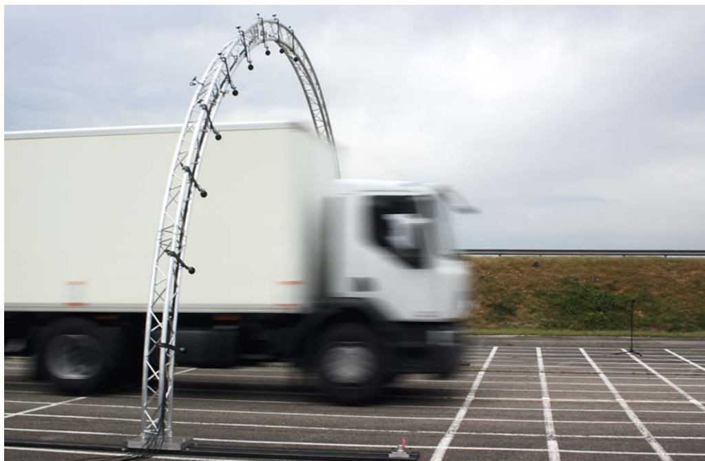
Mesure de la directivité du bruit émis par un camion
