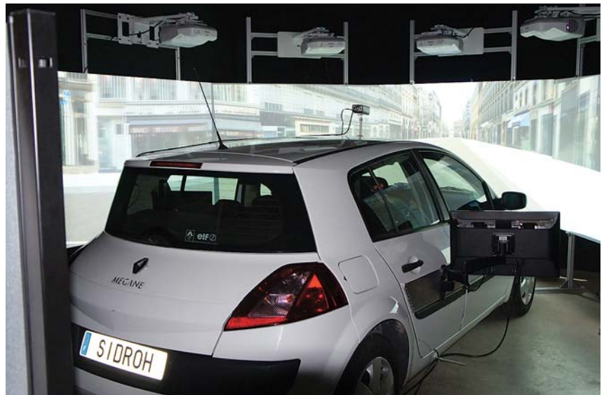
Le nouveau véhicule simulateur intégré dans son environnement instrumenté
