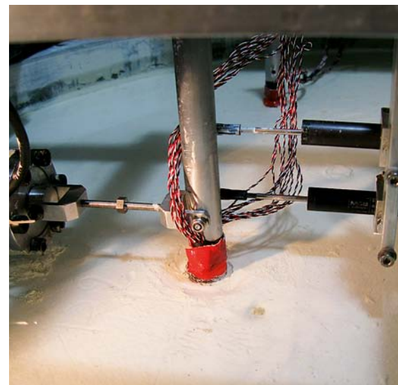
Modèle réduit de pieu sous chargement latéral (vérin à gauche, capteurs de déplacement à droite)
