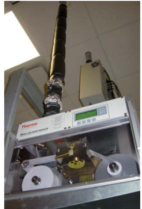
L'analyseur Sharp 5030 mesure en continu les particules fines dans l'air ambiant.
