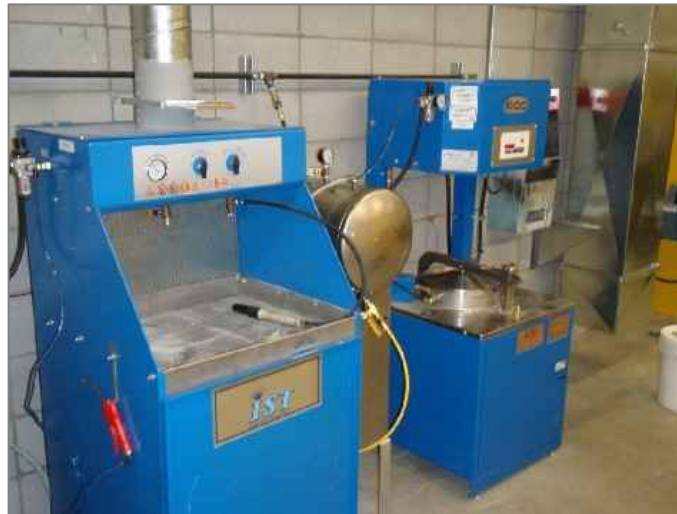
Système de lavage d'équipement d'application de revêtement et système de recyclage du diluant
