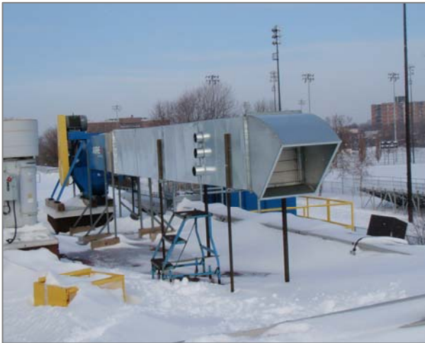
Vue de la caractérisation des émissions particulaires du dépoussiéreur de rechapage de pneus du centre de transport Legendre, effectuée en 2009.
