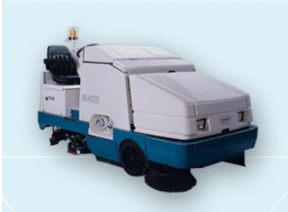
Les solides tels le gravier et les papiers répandus sur le plancher des garages, sont ramassés par les brosses situées à l'avant. Ils sont ensuite acheminés dans un récipient à bascule pouvant déverser directement les résidus récupérés dans les conteneurs de déchets solides. L'équipement de lavage est à l'arrière du balai; l'eau sale est récupérée dans un réservoir et déversée dans le réseau d'égout industriel du centre de transport.
