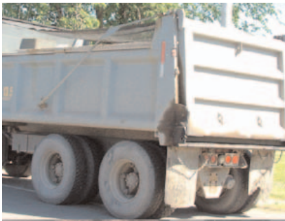
Figure 2-7 Bâche non conforme
