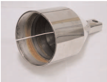
Figure 7-18 Système de prise d'éprouvette pour essais in situ
