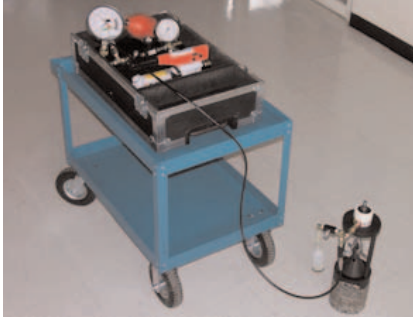
Figure 7-16 Appareillage de mesure de la force de liaison
