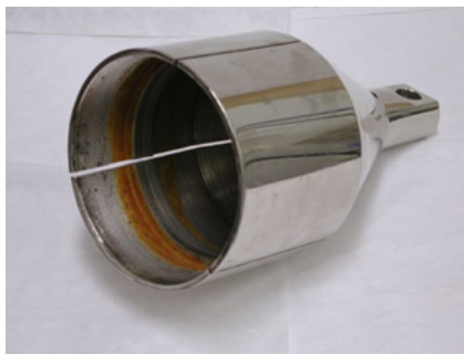
Figure 3-12 Système de prise d'éprouvette pour essais in situ
