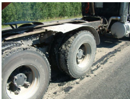
Figure 3-2 Arrachement du liant d'accrochage par les pneus
