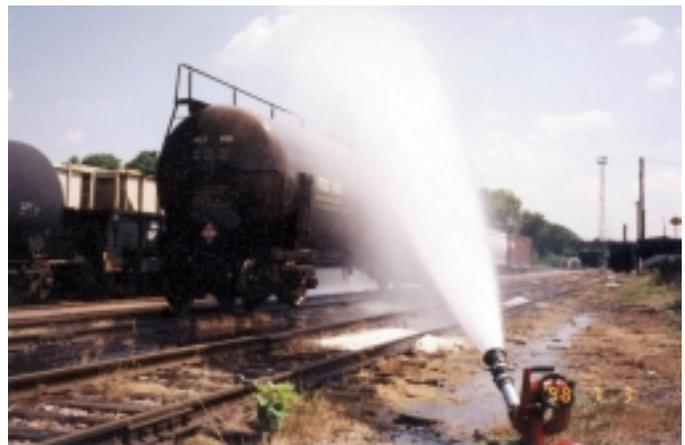
*Un wagon-réservoir de butanol refroidi par un service d'incendie au cours d'une intervention d'urgence.*
