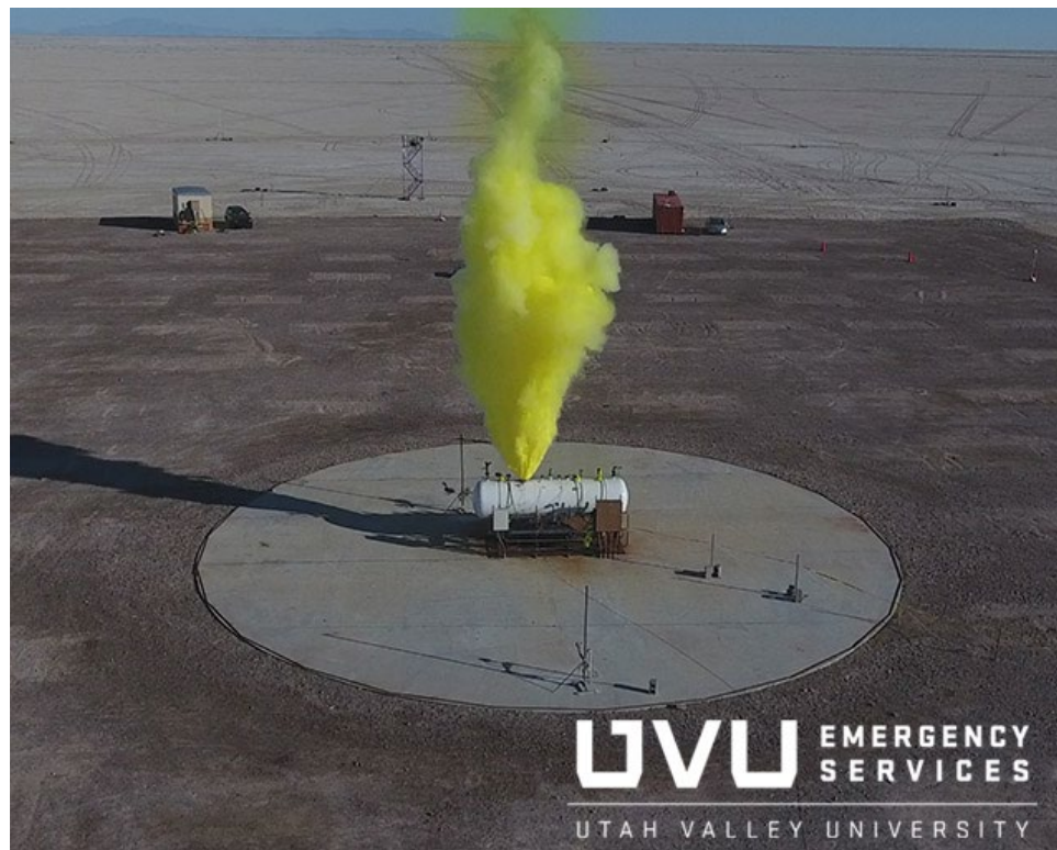
Un essai représentatif de libération de chlore montrant le nuage d'émissions toxiques et l'environnement d'essai.
