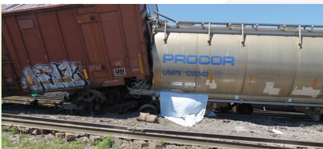
Wagon trémie (chargé de chlorate de sodium) impliqué dans le déraillement.
