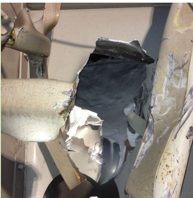
L'attelage du wagon couvert a percé le wagon-trémie, libérant du chlorate de sodium (sous forme fluide).
