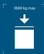
Exemple de marquages apposés sur un GRV souple en tissu de plastique avec doublure fabriqué en janvier 2011 et non conçu pour être empilé.
