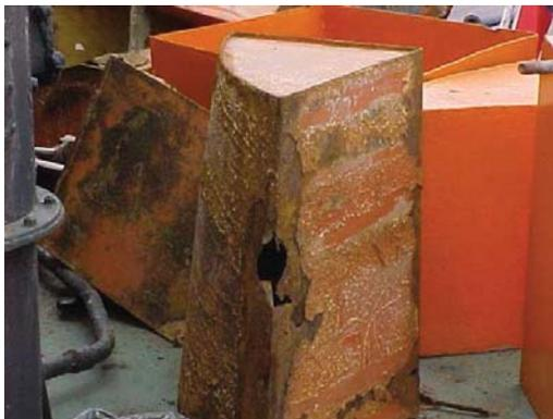
Corrosion des caissons de flottabilité des embarcations de sauvetage
