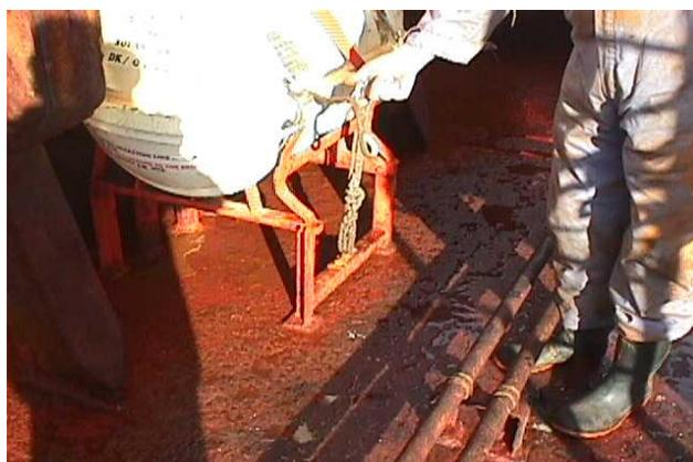
Mécanisme de libération du radeau de sauvetage rendu inopérant par l'usure.
