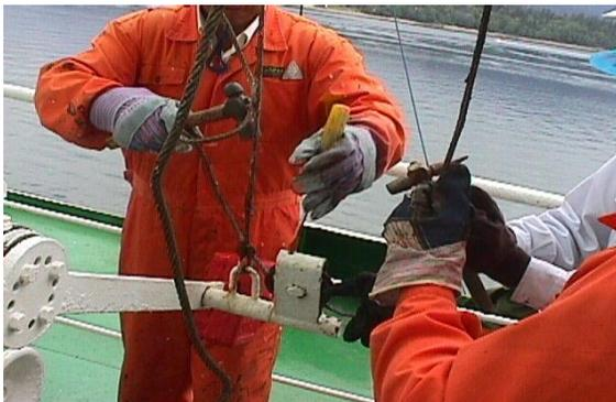
Le dispositif de mise à l'eau du canot de sauvetage doit être ouvert de force.
