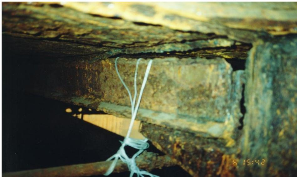
*Corrosion profonde de la structure du dessous du pont d'un vraquier.*
