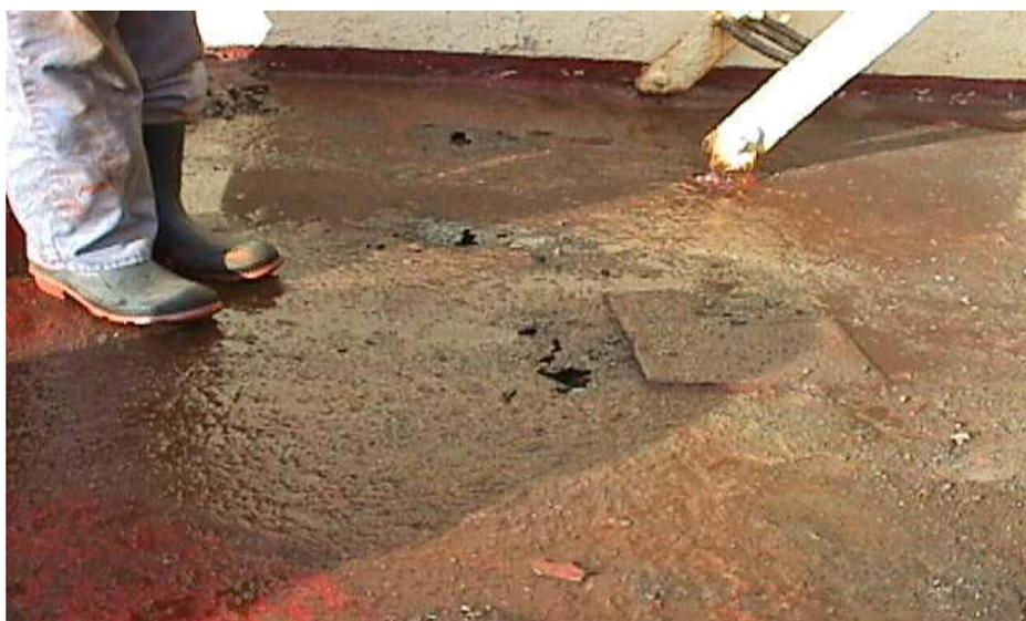
Bordé de pont corrodé pouvant mener à de sérieuses conséquences.
