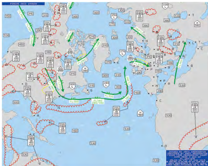
Figure 12.2a) – Carte de prévisions du temps significatif à haute altitude (SIGWX HI LVL)
