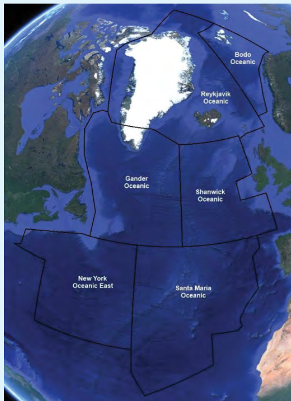
Figure 1.2 – NAT HLA entre le FL 285 et le FL 420 (disponible en anglais seulement)
