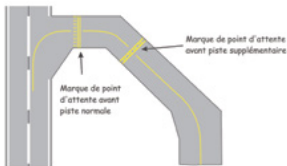
Figure 5.7 – Marques de point d'attente avant piste
