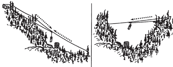
Figure 2.5 – Pont roulant sur câble aérien
