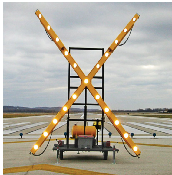
Figure 5.13 – Croix lumineuse indiquant la fermeture temporaire d'une piste au complet
