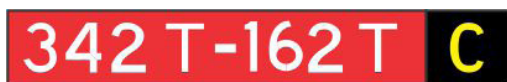
Figure 5.16 – Exemple de panneau de désignation de piste en région d'incertitude de compas
