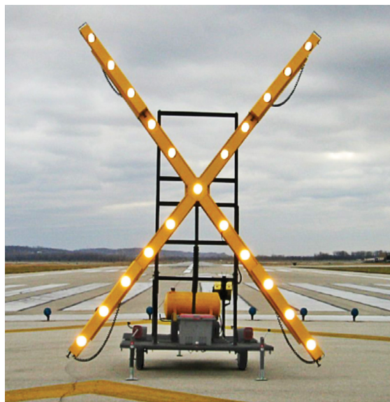
Figure 5.13 – Croix lumineuse indiquant la fermeture temporaire d'une piste au complet
