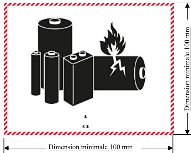
Marque pour les batteries au lithium
