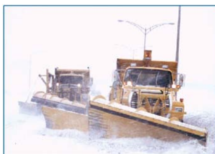
Un exemple de déneigement en tandem du ministère des Transports du Québec.
