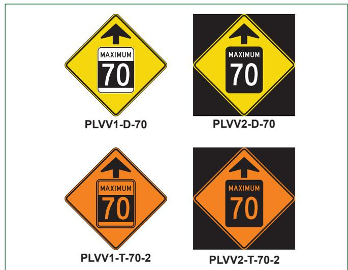
Figure 14 – Signal avancé de panneaux de limite de vitesse variable.
