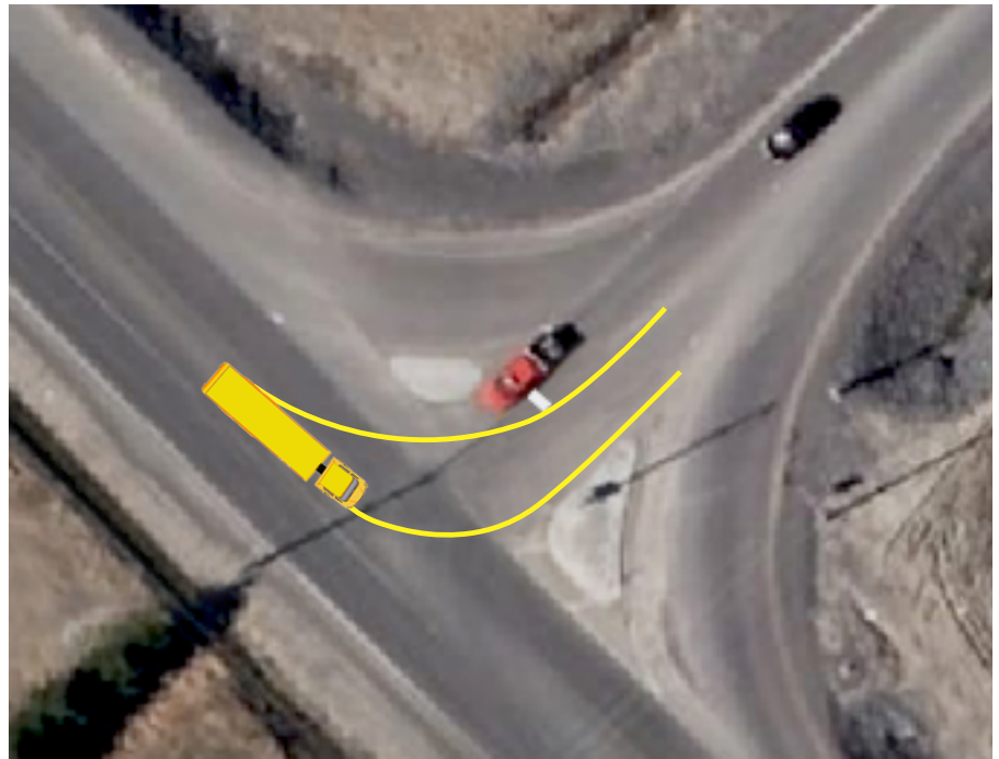
Figure 11 – Position de la ligne d'arrêt sur la route secondaire pour permettre le virage à gauche à partir de la route principale
