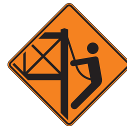
Figure 11 – Panneau « Travaux sur une structure de signalisation » (T-50-15)
