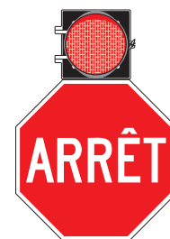
Figure 18 – Renforcement du panneau « Arrêt » ou « Stop » (P-10)
