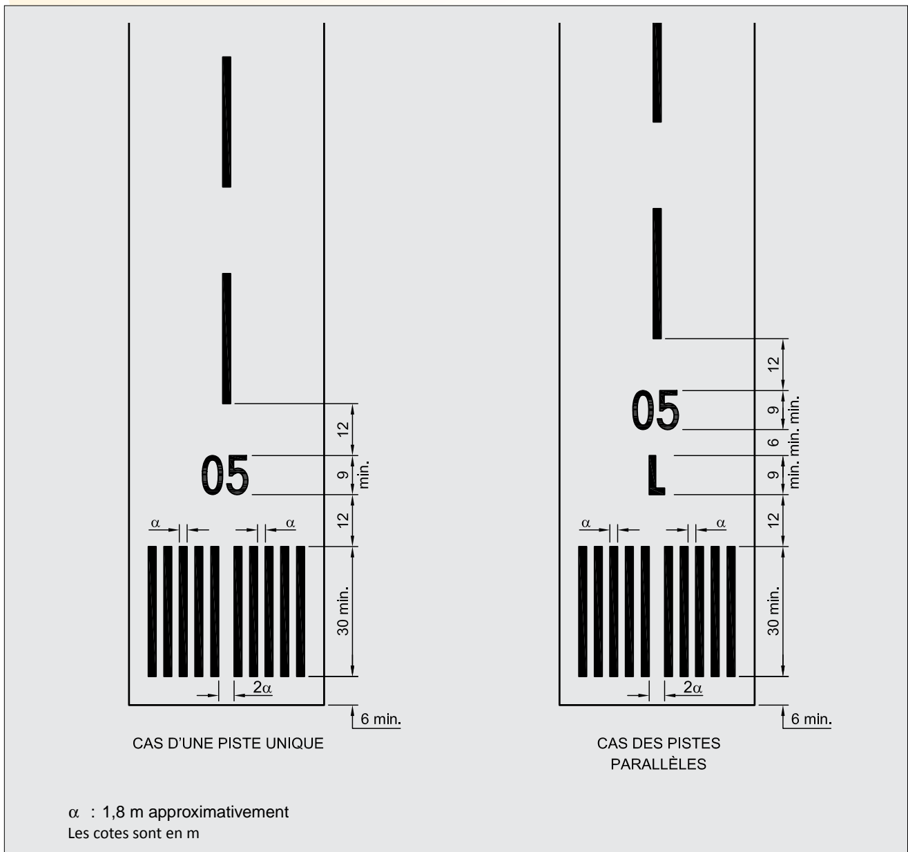
Figure 3 - Marques d'identification de piste, axe de piste et de seuil de piste
