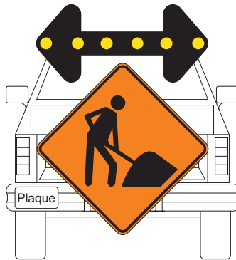
Figure 10 Montage des panneaux sur un véhicule d'accompagnement
