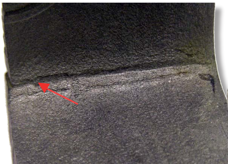
FIGURE 4 : Pièce d'attache formée par pliage à froid
