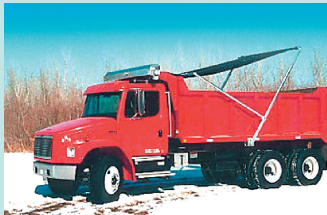
Système mécanisé : levier complémentaire fixé au levier principal
