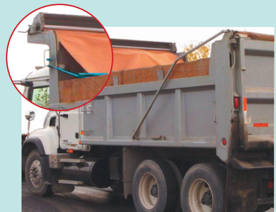
Système mécanisé : levier complémentaire fixé à la partie avant de la benne
