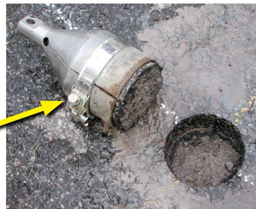
**AMAC : Appareil de mesure de l'adhésion des couches**
