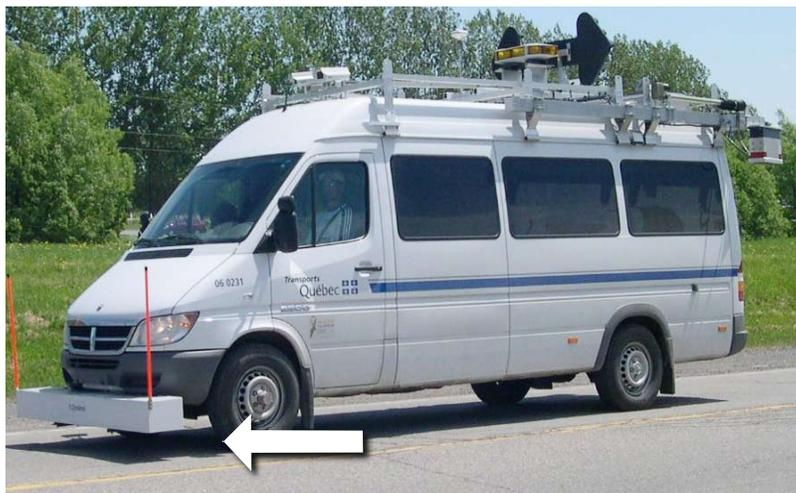
**Le profilomètre inertiel se trouve à l'avant du véhicule multifonction**
