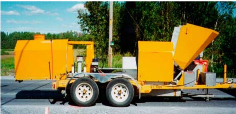
**Déflectomètre à masse tombante (FWD)**
