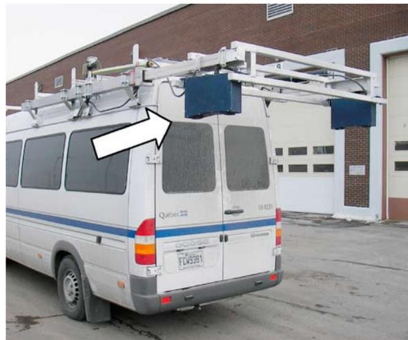
**Système automatisé de mesure de la fissuration et des ornières.**
