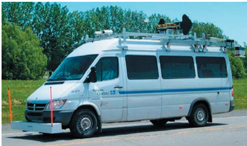
Véhicule d'auscultation des chaussées du MTQ
