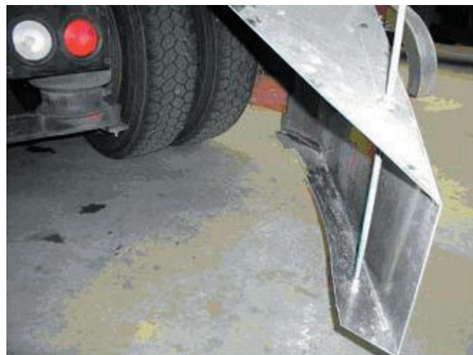
Figure 15 : Tuyère installée à l'arrière du tandem du tracteur.
