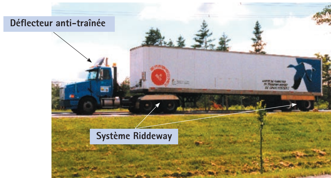
Figure 10 : Déflecteur antitraînée et système antiéclaboussures de type Reddaway.
