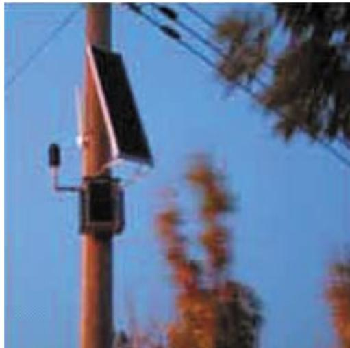
L'acquisition des données s'effectuait en continu pendant 24 heures. À un intervalle de temps variable, la station maître effectuait des requêtes aux stations esclave afin de recueillir les données, puis elle les transmettait au serveur de la firme par Internet.
