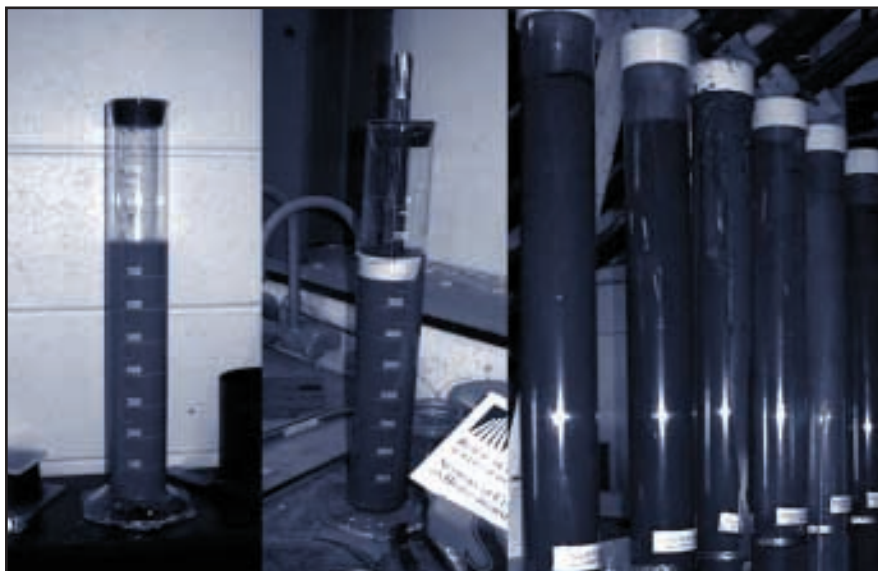
Figure 2 : Ressuage statique (sans toron), essai de la mèche (avec toron) et tube vertical (sans toron) (tiré de Côté, 2002).
