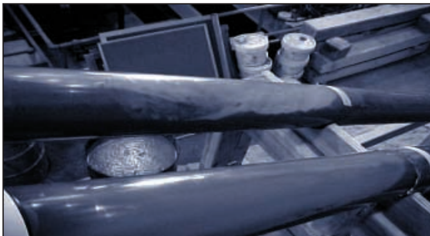
Figure 4 : Gonflement important (tiré de Côté, 2002).
