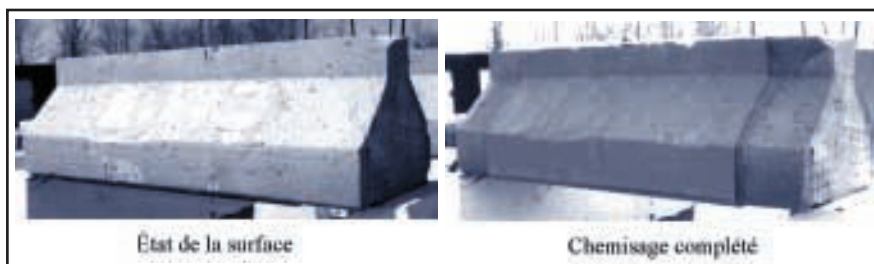
Figure 4 : Poutrelles du groupe 2 après les essais
