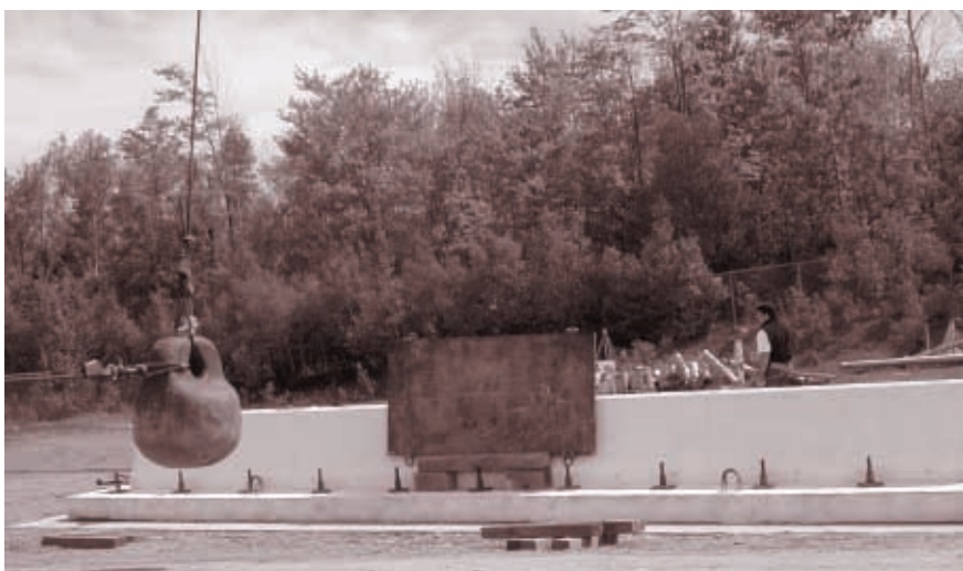
Photo 3: Essai d'impact par pendule équivalent
