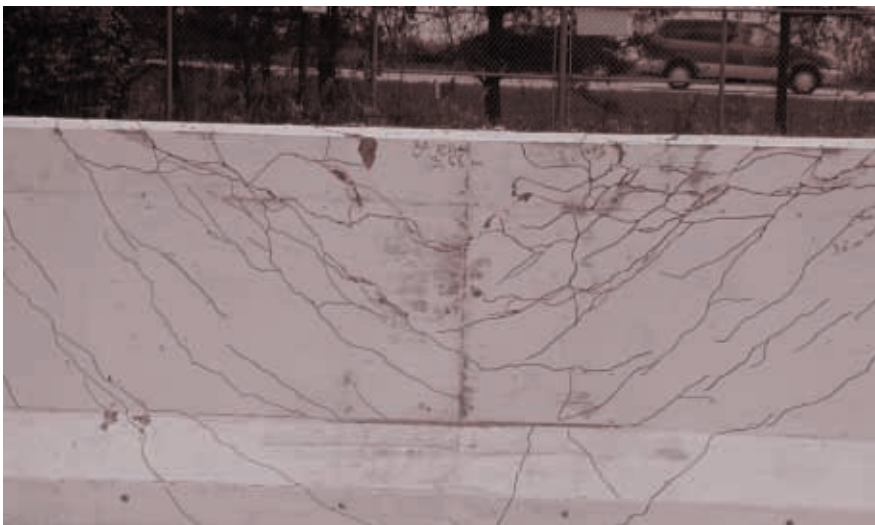
Photo 6 : Essai destructif (vue avant)
