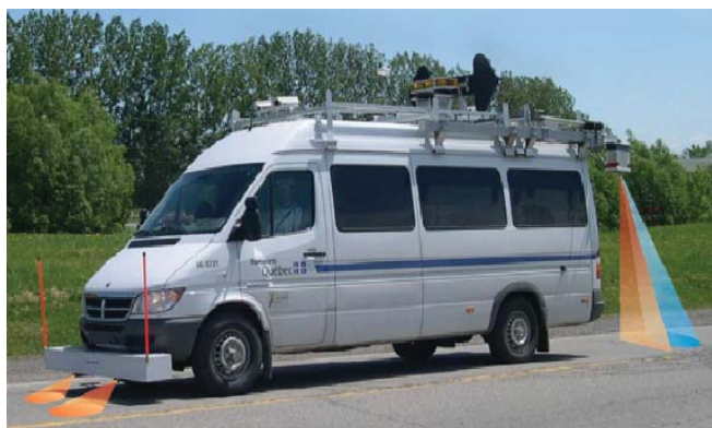
Photographie 1 : Véhicule d'auscultation des chaussées du MTQ
